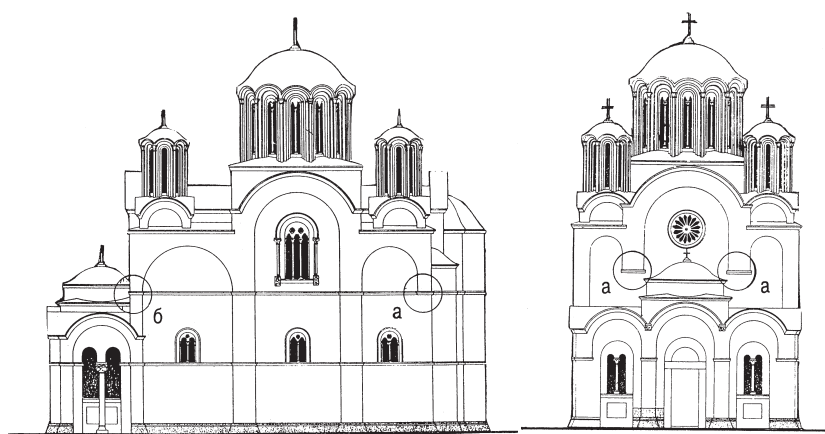
Реконструкција мајичне цркве манастира Светих Арханђела по проф. Др Слободану Ненадовићу са назначеним slabим тачкама у разрешавању ослонаца пиластара а. пиластри без конструктивног ослонаца који „висе“ на конзолама, б. несразмерно узак пиластар
